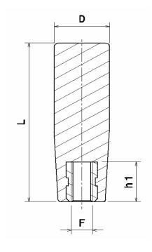
Material: Parte plástica em Baquelite Parte metálica em Aço Zincado
